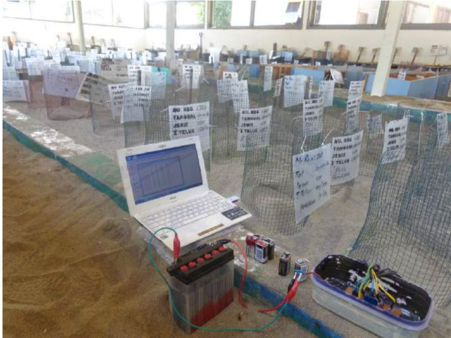
Gambar 5. Seperangkat alat termo- higrometer yang digunakan untuk mengukur suhu dan kelembaban pasir dalam sarang
