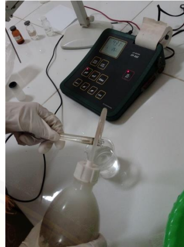
Gambar 14. Persiapan proses pengukuran air cucian zeolit alam teraktivasi dengan pH meter
