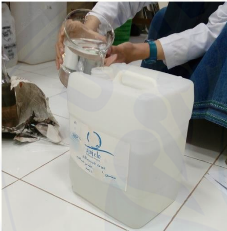
Gambar 9. Pencampuran dengan aquades yang lainnya untuk mendapatkan konsentrasi H 2 SO 4 0,15 N
