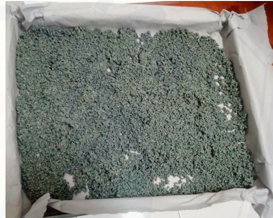
Gambar 16. Persiapan pengovenan untuk mengurangi kadar air
