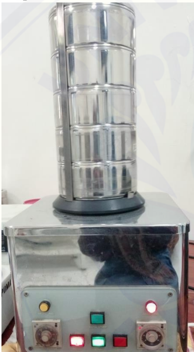
Gambar 3. Proses pengayakan zeolit untuk mendapatkan ukuran yang sama
