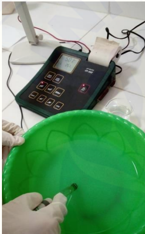
Gambar 15. Pengukuran air cucian zeolit alam teraktivasi dengan pH meter
