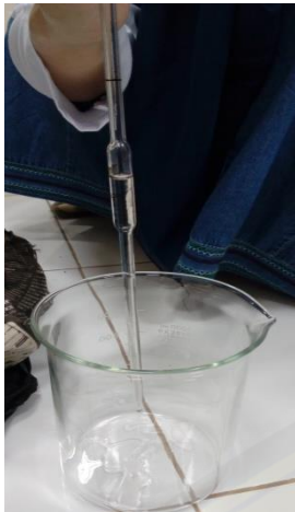
Gambar 7. Proses pencampuran H 2 SO 4 dengan aquades
