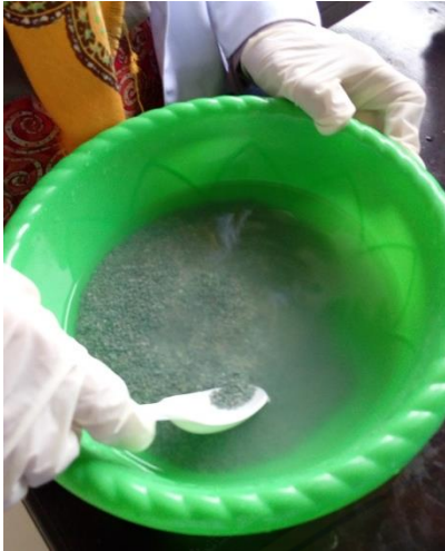
Gambar 13. Proses penetralan zeolit alam teraktivasi dengan aquades
