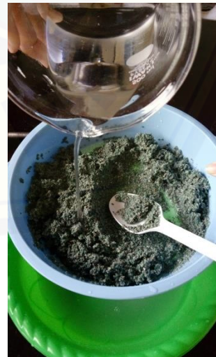
Gambar 12. Proses penyaringan zeolit alam teraktivasi dan proses penetralan
