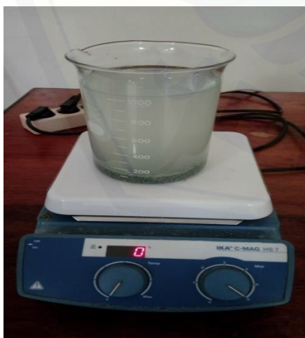
Gambar 11. Proses pengadukan dengan kecepatan 600 rpm selama 3 jam
