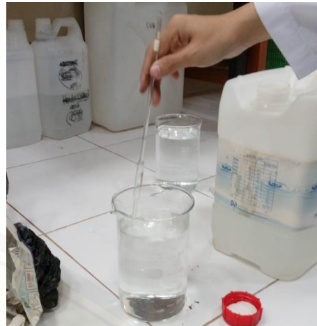
Gambar 8. Pencampuran H 2 SO 4 dengan sedikit aquades agar tercampur rata
