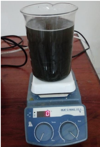
Gambar 25. Proses pengadukan limbah cair dengan zeolit alam teraktivasi pada kecepatan 600 rpm selama 60 menit
