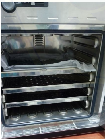
Gambar 17. Pengovenan zeolit alam teraktivasi dalam suhu 105°C selama 3 jam
