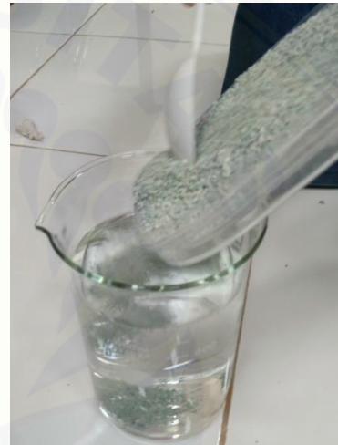
Gambar 10. Memasukkan 100 gr zeolit alam ke dalam 1 L larutan konsentrasi H 2 SO 4 0,15 N
