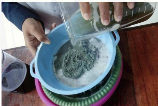
Gambar 27. Penyaringan zeolit alam teraktivasi dari limbah cair
