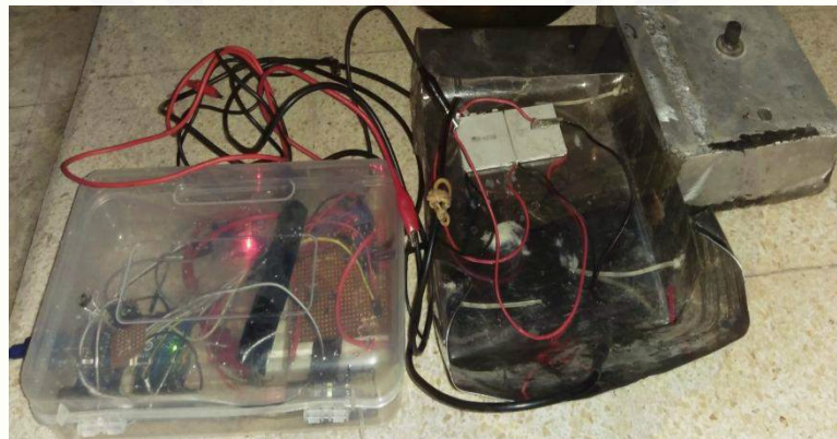
Gambar 4.7 TEC yang tersusun secara seri
