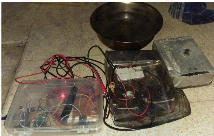
Pengujian alat ukur potensi energi menggunakan TEC-12706
