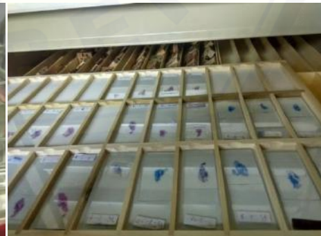
Gambar E.10 Pewarnaan menggunakan staining jar sesuai urutan tahapan. Preparat yang siap diamati.
