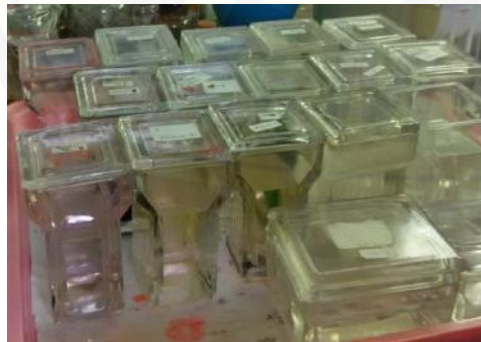
Gambar E.10 Pewarnaan menggunakan staining jar sesuai urutan tahapan. Preparat yang siap diamati.
