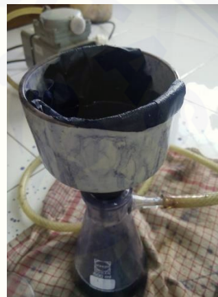
Gambar 16. Penyaringan arang aktif ampas kopi menggunakan corong buchner
