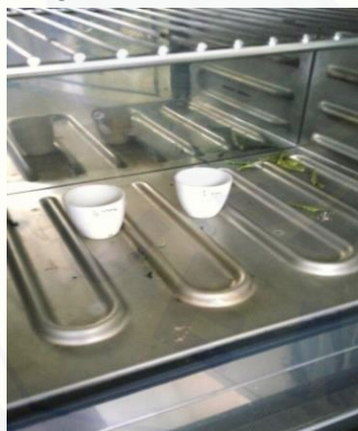
Gambar 11. Uji kadar air arang aktif ampas kopi
