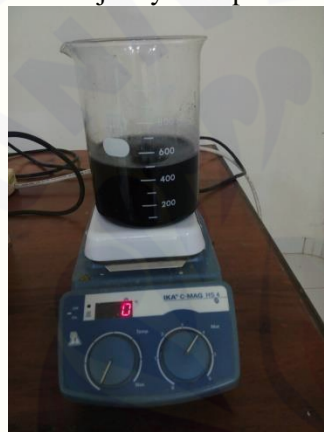
Gambar 15. Pengontakan arang aktif ampas kopi ke dalam limbah cair batik menggunakan magnetic stirrer
