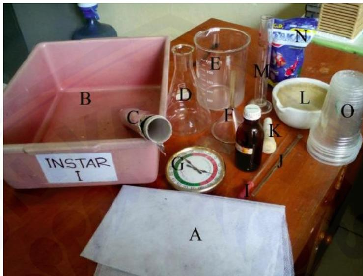
Gambar C.1 Beberapa Alat dan Bahan yang Digunakan dalam Penelitian A. Kain kasa, B. Bak plastik, C. aluminium foil, D. tabung erlenmeyer, E. beaker glass, F. corong, G. higrometer, H. eosin, I. pipet tetes, J. Pengaduk, K. Alu, L. mortar, M. Gelas ukur, N. Pakan ikan, O. Gelas plastik
