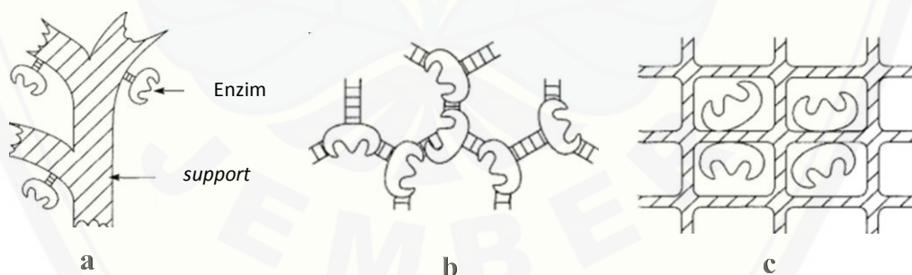
Gambar 2.9 Metode imobilisasi enzim; (a) metode carrier binding ; (b) metode cross linking ; (c) metode penjerapan (Sumber: Katzir, 1993)
