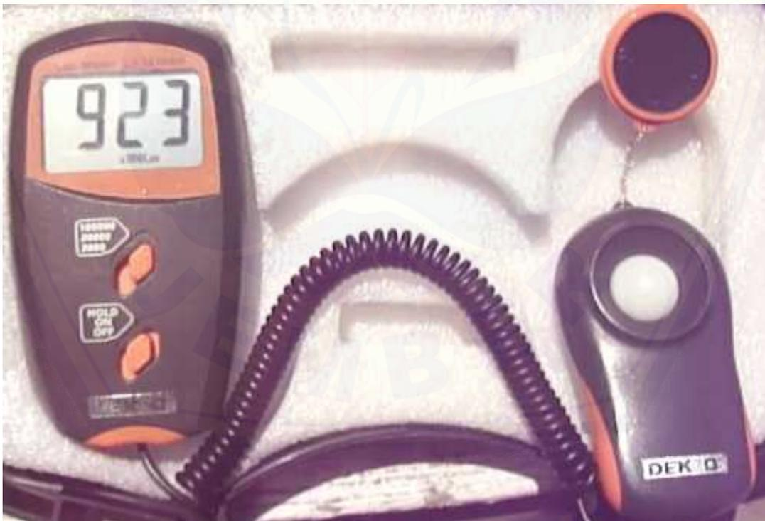
Pengujian Intensitas Radiasi Matahari menggunakan Lux Meter
