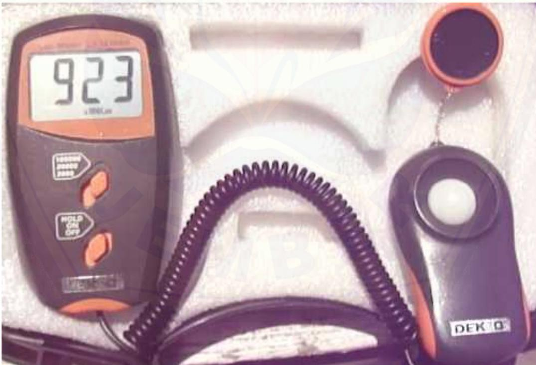
Pengujian Intensitas Radiasi Matahari menggunakan Lux Meter
