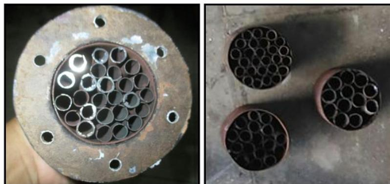
Gambar 3. Produk *catalytic converter* sistem *honeycomb* pada knalpot inovatif hasil perancangan dan pembuatan
