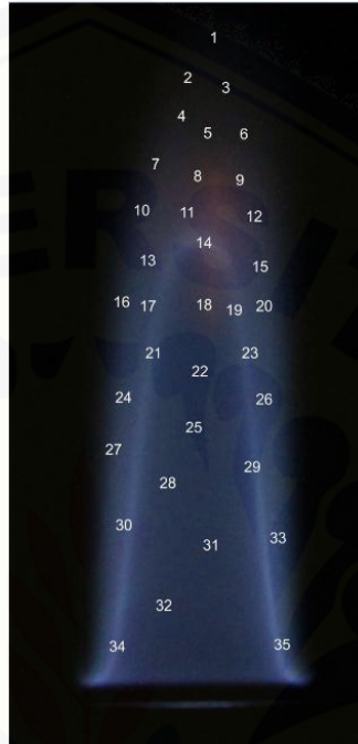
Gambar 4.2 Warna api dan titik api biogas sebelum purifikasi
