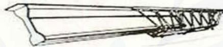
Gambar 2.10 Pemikul yang dapat digeser dengan pemikul dalam (dinding penuh) dan pemikul luar (kerja rangka). (Wigbout, 1987:90)
