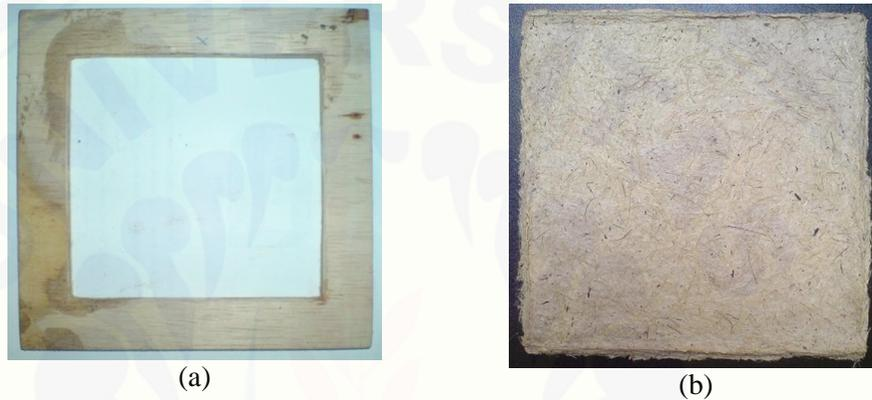
Gambar 3.2 Cetakan serat ampas tebu dan hasil cetakan. (a) Alat cetak; (b) Serat ampas tebu setelah dicetak
