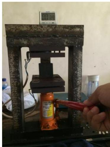
Gambar 3.8 Proses pengepresan komposit dengan *hot press machine*
