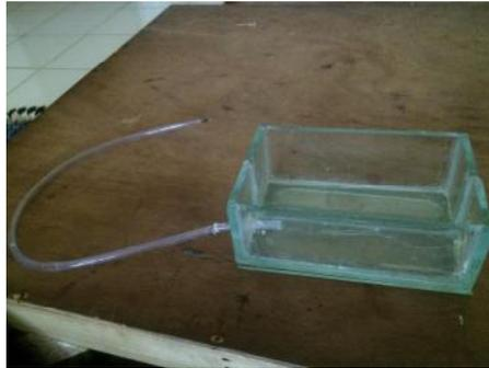
Gambar 3.3 *Cooler* sebagai pembeda suhu dalam sistem alat pengukur konduksi panas bahan
