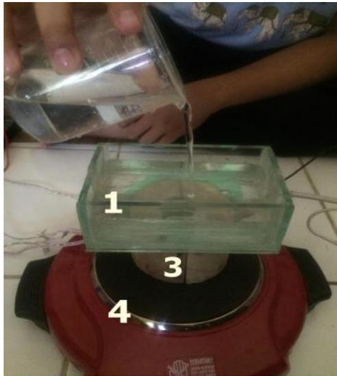
Gambar 3.9 Konstruksi sistem alat pengukur konduktivitas panas bahan
