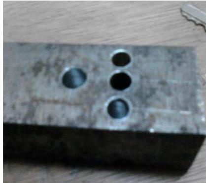
Gambar 3.4 Batangan besi yang dilubangi untuk peletakan kepala sensor dan termometer
