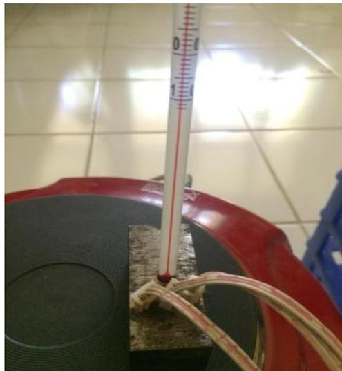
Gambar 3.5 Kepala sensor dan termometer diletakkan pada lubang yang disediakan
