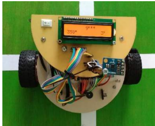
Gambar 3.17 Pengujian Sensor Kompas
