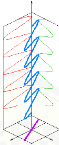
Gambar 2.2 Polarisasi linier (Sumber : Pratama, 2013)
