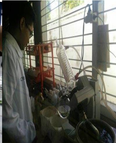
Penguapan dengan Rotary Evaporator
