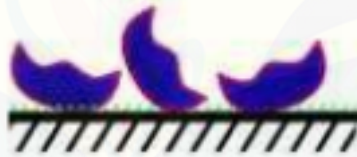
Gambar 2.13 Imobilisasi secara adsorpsi (Kennedy,1999)
