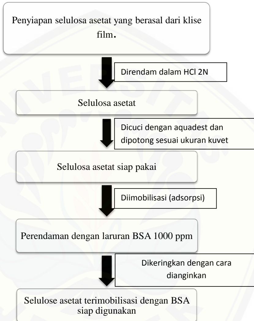
Gambar 3.2 Diagram alur imobilisasi BSA
