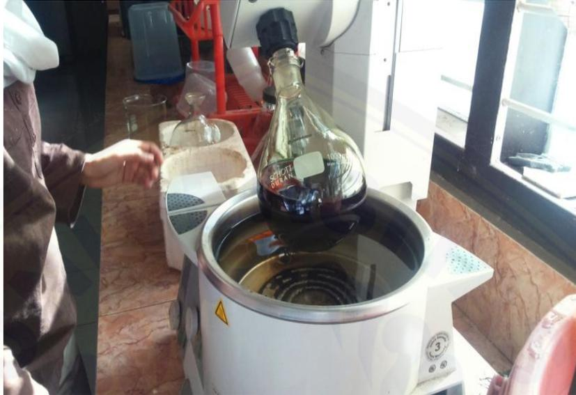
Proses Penguapan dengan Rotary Evaporator
