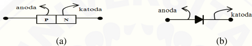
Gambar 2.5 Susunan dan lambang dioda (a) susunan dioda sambungan p-n , (b) lambang dioda (Sumber : Sutrisno, 1984)
