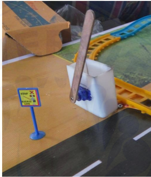
3.4.2 Gambar pembuatan palang pintu kereta api
