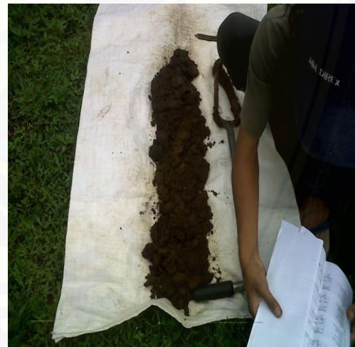
Gambar 14 l. Contoh tanah hasil pengeboran di SPT 8 (2)
