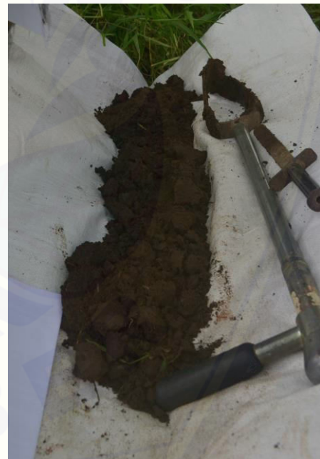
Gambar 14 h. Contoh tanah hasil pengeboran di SPT 4 (2)
