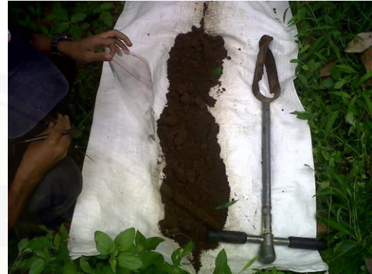
Gambar 14 f. Contoh tanah hasil pengeboran di SPT 3 (2)
