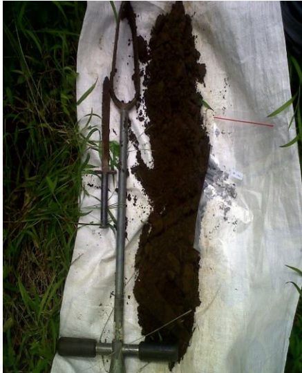
Gambar 14.a Contoh tanah hasil Pengeboran di SPT 1 (1)
