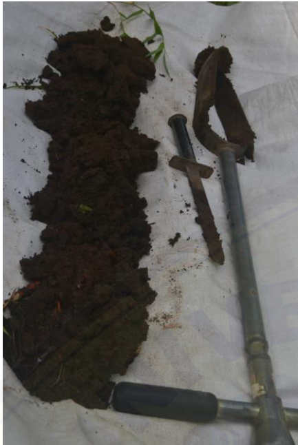
Gambar 14 i. Contoh tanah hasil Pengeboran di SPT 7 (1)
