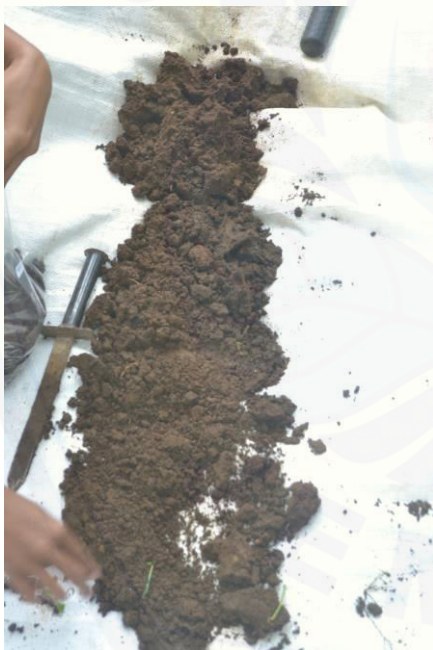
Gambar 14 g. Contoh tanah hasil Pengeboran di SPT 4 (1)
