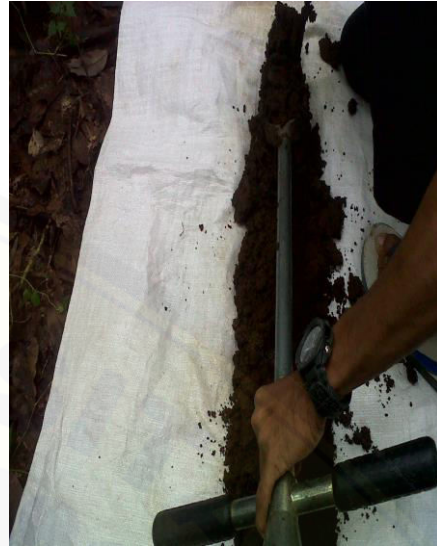
Gambar 14.b Contoh tanah hasil pengeboran di SPT 1 (2)
