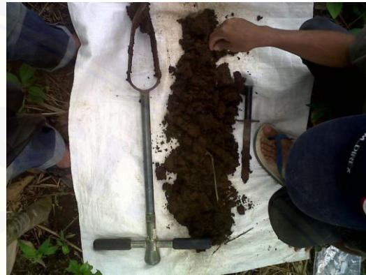
Gambar 14 n. Contoh tanah hasil pengeboran di SPT 9 (2)
