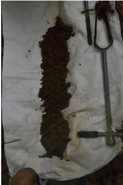
Gambar 14 m. Contoh tanah hasil pengeboran di SPT 9 (1)
