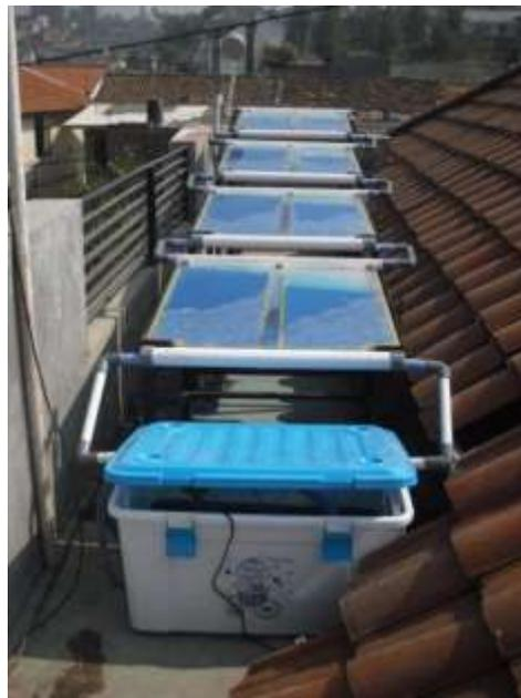
Gambar 5. *Scale-up* dari IFP fotoreaktor dengan penambahan jumlah panel reaktor.
