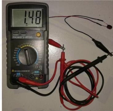
Pengukuran Induktor pada konverter *buck* untuk baterai *handphone*
