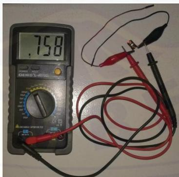
Pengukuran Induktor pada konverter *boost* untuk baterai *laptop*
