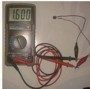
Pengukuran Induktor pada konverter *buck* baterai *back-up*
