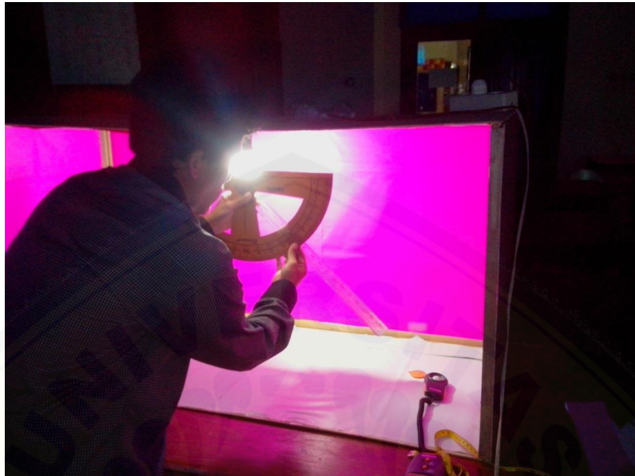
Gambar 3. Pengukuran sudut dari lampu terhadap sensor
