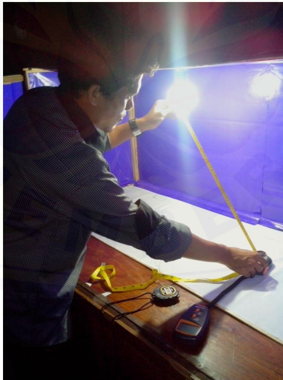
Gambar 2. Pengukuran jarak lampu ke sensor
