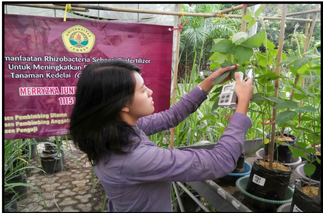
Pengukuran Kandungan Klorofil Daun menggunakan Chlorophyllmeter SPAD-502 Minolta pada Umur Tanaman 35 HST
