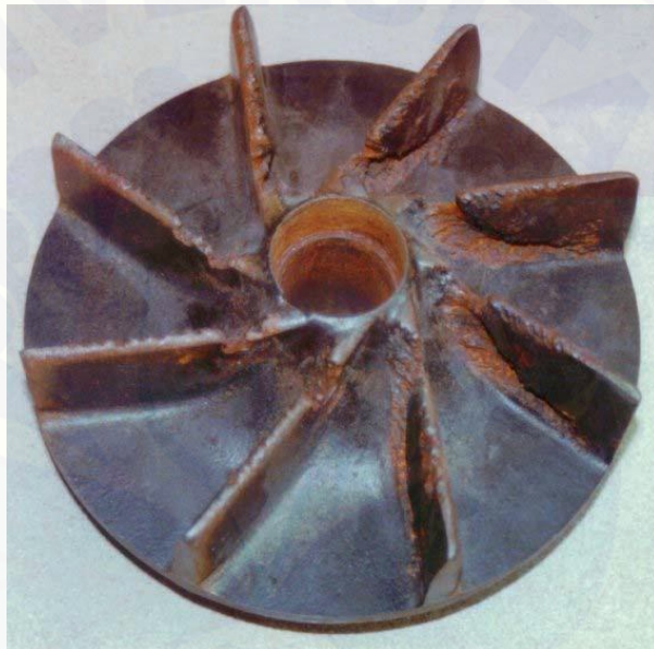
Gambar 2.15 Kerusakan impeller karena kavitasi
