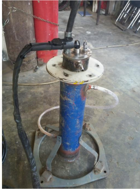
Gambar 3.3 : Reaktor Mesin DC thermal plasma
