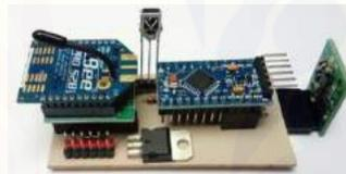
Gambar 3.15 IMU (*Inertial Measuring Unit*) Arduino Pro Mini Board Arduino Pro Mini dibentuk dalam satu modul IMU dengan komponen lain agar mempermudah proses pemrograman juga meringkas pengkabelan.
