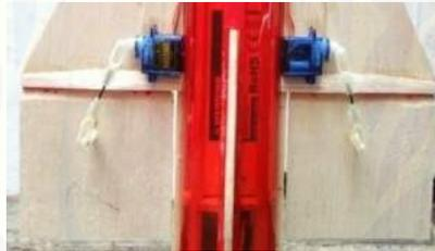
Gambar 3.6 Penyambungan servo dengan sirip
