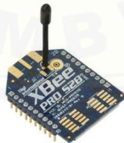
Gambar 2.17 Modul *Wireless*XBee PRO S2B
