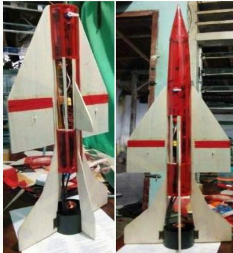
Perancangan komponen roket di dalam rangka roket
