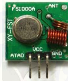
Gambar 2.6 Modul TLP 433,92A (Sumber : Muntaha, M, 2009)
