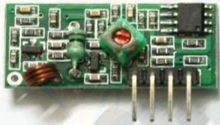
Gambar 2.7 Modul RLP 433,92A (Sumber : Muntaha, M, 2009)
