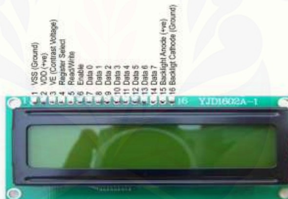
Gambar 2.9 LCD karakter 16x2 (sumber : http://elektronika – dasar )
