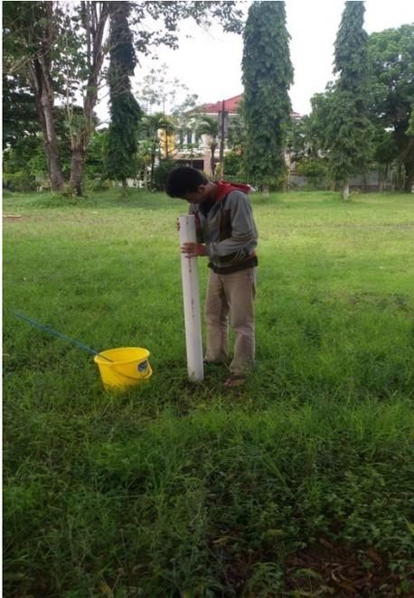
B.1 Pemasangan alat uji permeabilitas
