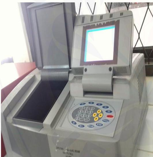
Gambar 11. Spektrofotometri yang digunakan untuk Uji Betakaroten
