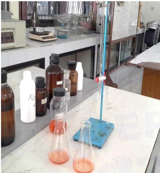
Gambar 9. Alat Titrasi Uji Protein
