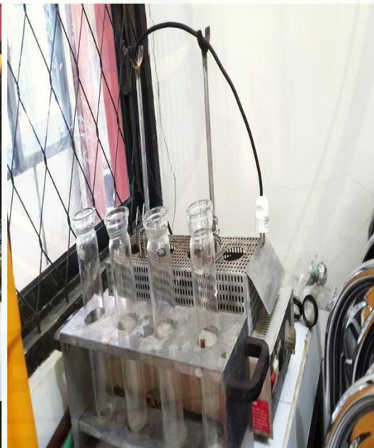
Gambar 8. Alat Destruksi Uji Protein
