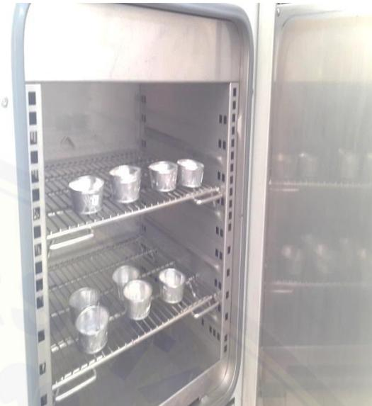
Gambar 10. Alat Oven Udara Uji Air
