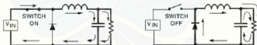
Gambar 2. 2 Arah arus pada saat saklar Switch ON dan OFF (Danie Novin Sugiharto,2010)
