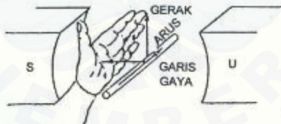
Gambar 2. 14 Penentuan arah gerak kawat berarus
