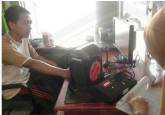
Gambar 1. Pengukuran Kelelahan Kerja dengan Reaction Timer Pada Siang Hari
