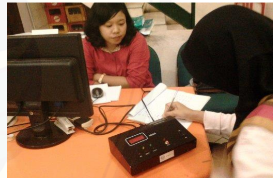
Gambar 3. Pengukuran Kelelahan Kerja dengan Reaction Timer Pada Malam Hari
