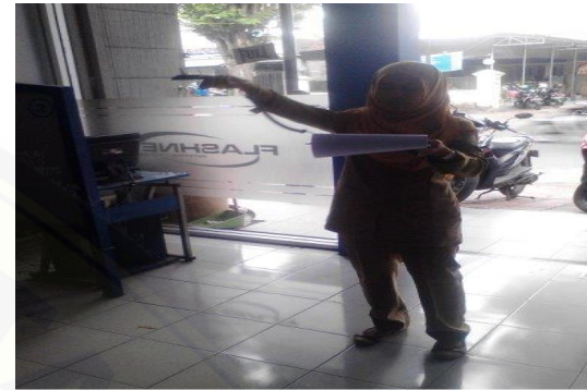
Gambar 2. Pengukuran Intensitas Pencahayaan dengan Lux Meter pada Siang Hari
