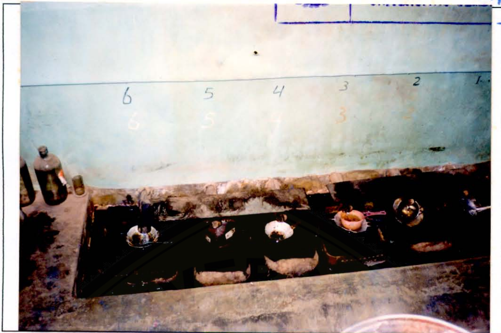
Gambar 12. Kaleng Penampung Minyak Kenanga yang Diredam dalam Air Dingin
