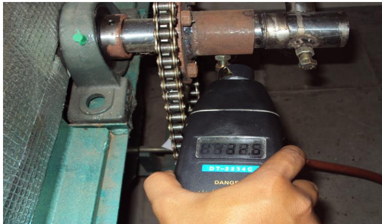
Gambar 5.11 Pengukuran putaran silinder sangrai
