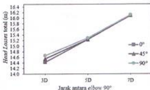
Gambar 10. Grafik head losses total terhadap jarak antara elbow pada arah keluaran
