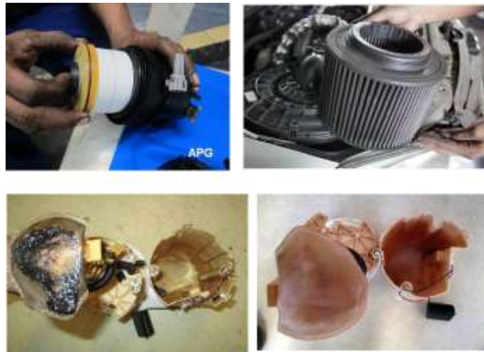
Contoh filter di dalam tangki yang terkontaminasi (kiri) dan yang relatif bersih. Gunakan selalu BBM diesel bersulfur rendah
