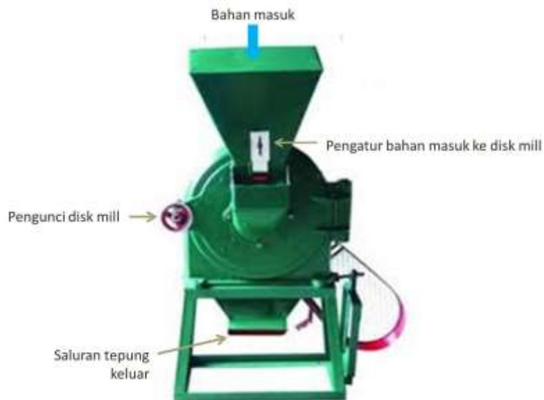
Gambar 1. Bagian Penepung Ikan Disk Mill
