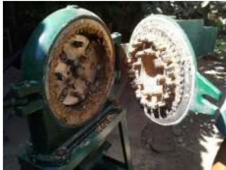
Gambar 9. Penggumpalan akibat bahan kurang kering dan saringan terlalu halus.
