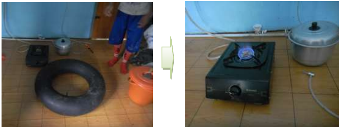
Gambar 22. Praktek Operasional Kompor Gas dengan Memanfaatkan Ban Mobil Bekas sebagai Penampung Sementara Biogas
