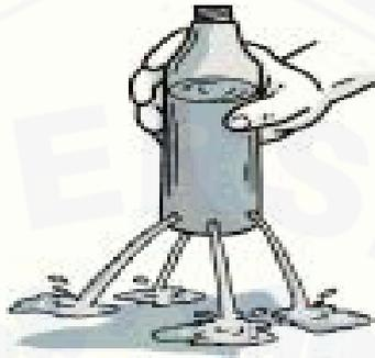
9. Ambil botol plastik yang telah dilubangi secara vertikal dari atas ke bawah, kemudian sumbat lubang dengan penyumbat. Isi botol tersebut dengan air sampai penuh. Lepaskan penyumbat dari lubang-lubang botol secara bersama-sama. Amati apa yang terjadi!
