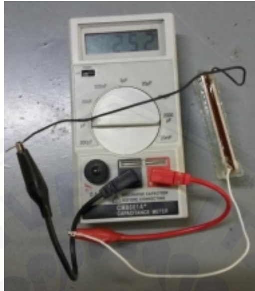
Gambar I.3 Pengukuran kapasitansi larutan cuka menggunakan kapasitansimeter
