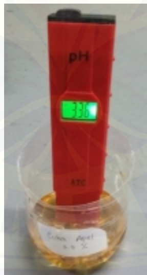
Gambar I.2 Pengukuran pH larutan cuka menggunakan pH meter digital
