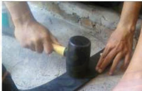
**Gambar 3.7** Proses perekatan sambungan *belt* dengan palu karet (Amril, 2015)
