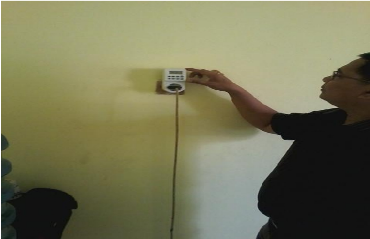
Penggunaan digital timer untuk sistem pengaturan penyiraman
