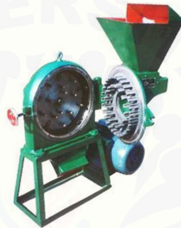
Gambar 2.2 Mesin Penepung Tipe Piringan ( Disc Mill )
