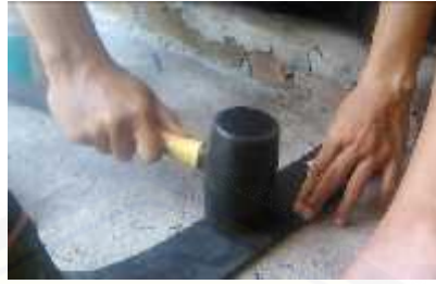
Gambar 3.22 Proses perekatan sambungan belt dengan palu karet
