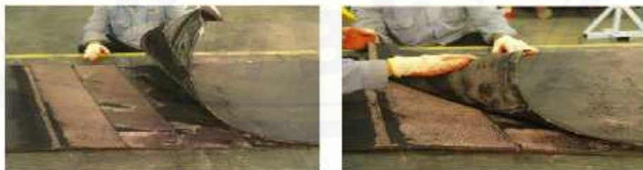
Gambar 3.17 Pengepasan sambungan belt
