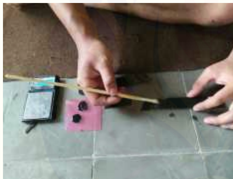
b. Proses Pengeleman dan Penambahan Material berupa Tie Rubber
