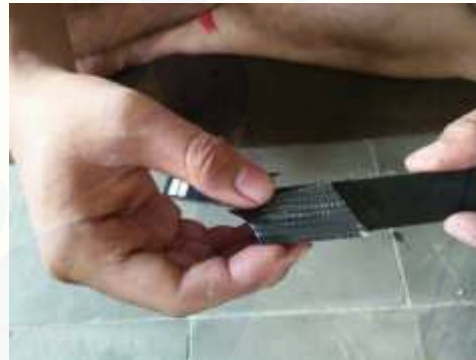
b. Proses Pengeleman dan Penambahan Material berupa Tie Rubber
