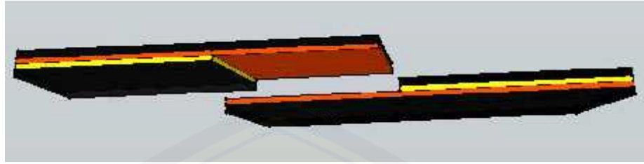
Gambar 3.15 Proses Matching belt pertama dengan kedua
