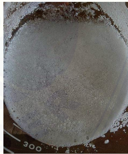
Hollow microspheres natrium diklofenak yang terbentuk dalam fase aqueous
