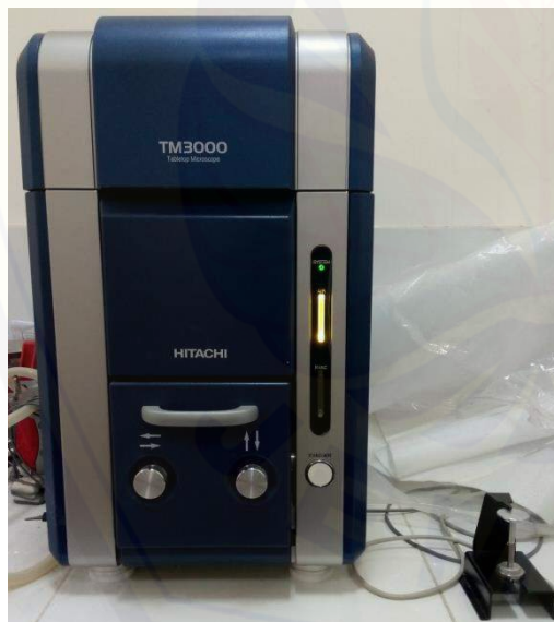
Penentuan morfologi dan ukuran partikel hollow microspheres natrium diklofenak menggunakan SEM
