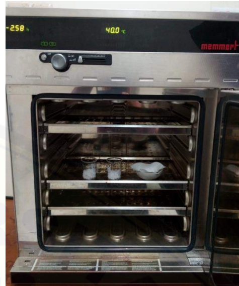
Proses pengeringan serbuk hollow microspheres menggunakan oven
