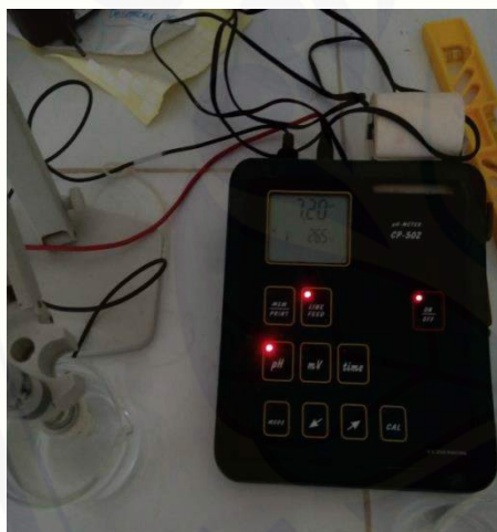
Proses pengujian pH larutan dapar fosfat
