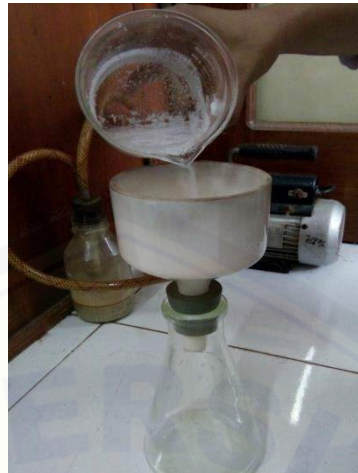
Proses penyaringan hollow microspheres natrium diklofenak yang terbentuk menggunakan vacum filtration dan corong buchner
