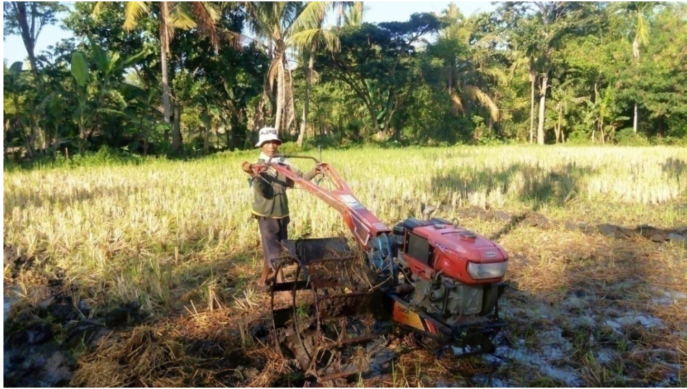
Gambar 2. Pengolahan Tanah menggunakan roda 1 (modifikasi 1)
