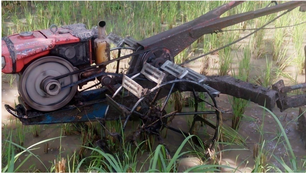
Gambar 6. Pengolahan Tanah menggunakan roda 3 (dari pabrik)
