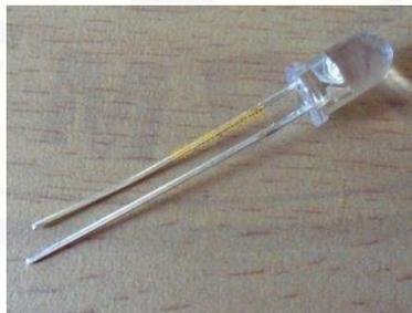
Gambar 2.3 Sensor Fotodioda
