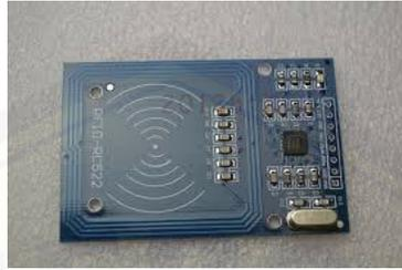
Gambar 2.2 Salah satu contoh bentuk fisik RFID Reader
