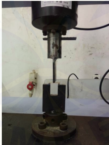
Gambar 3.3 Arah pemberian gaya dengan kecepatan 1 mm/menit (Sumber: Dokumentasi pribadi)
