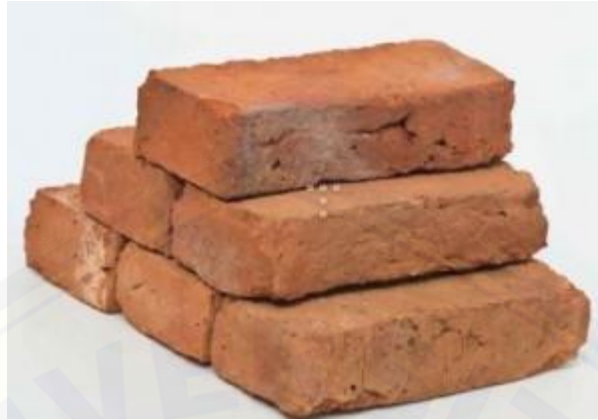
Gambar 2.3 Batu Bata yang Dipakai Untuk Bahan Material Dinding (Kamali, 2014)
