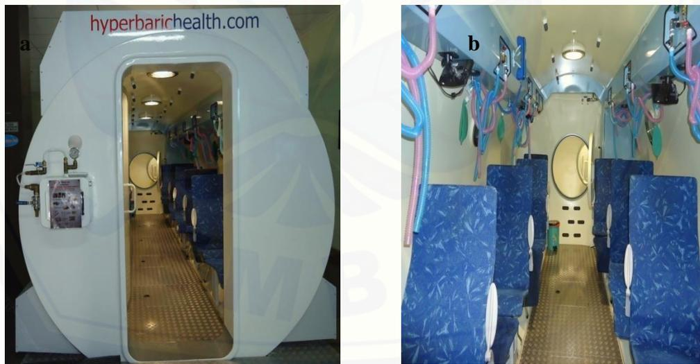
Gambar 3.1 *Multiplace chamber* (a) tampak luar dan (b) tampak dalam
